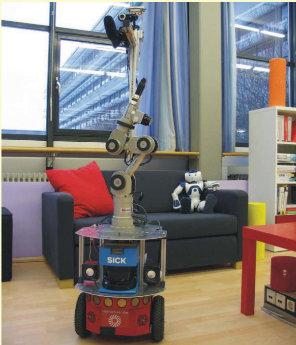
Der Serviceroboter „Kate“ kann einen Tisch abräumen und auf Sprachkommandos reagieren
