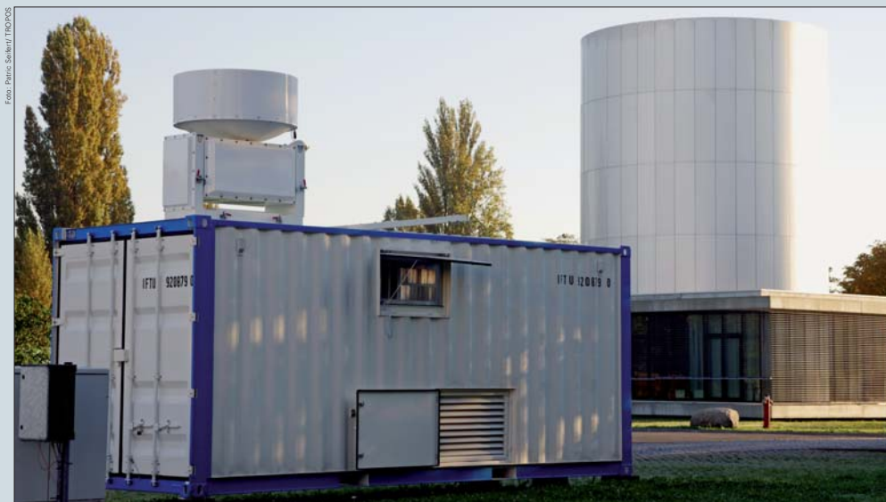
Das mobile Wolkenradar LACROS ist eines von 20 Fernerkundungsgeräten, die während der Messkampagne HOPE zum Einsatz kommen, um möglichst viele Wettersituationen einzufangen und so das Wissen über Wolken- und Niederschlagsbildung zu verbessern.
