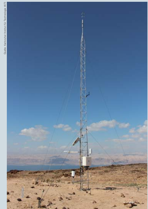
Mit meteorologischen Messmasten in Jordanien und Israel beobachten die Wissenschaftler Wetter und Klimaänderungen
